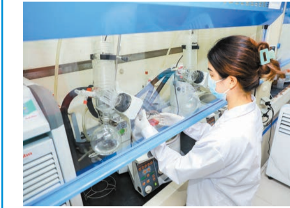
技術人員正在進行兒童用品紡織材料偶氮檢測前處理。廣州海關供圖
